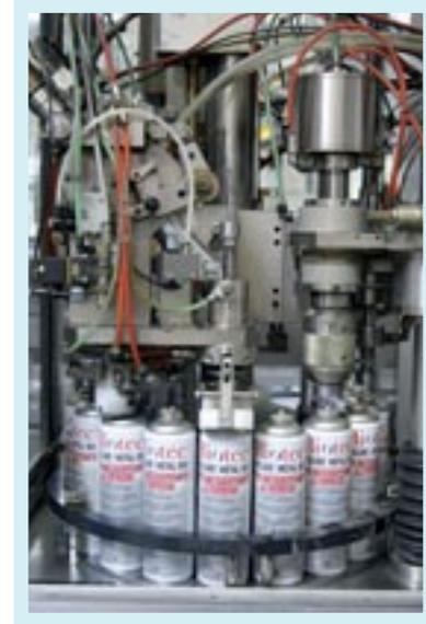
3 lignes de conditionnement entièrement automatisées, d'une capacité de 60 boîtiers/minute par machine.
