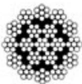
En multipliant le nombre de torons, on diminue les surfaces de contact avec les poulies ou les tambours. Les câbles anti-giratoires limitent les problèmes de torsion.
