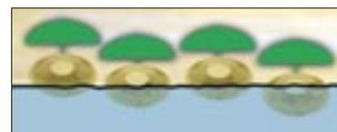
Simultanément, les molécules d'ÉTERNA® 3000 vont réagir et être fortement adsorbées sur les surfaces engendrées par la coupe. Elles vont ainsi abaisser considérablement le coefficient de frottement.
