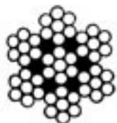
Tous les câbles, qu'ils soient destinés au tirage, au levage, à l'extraction, à la traction, y compris au transport des personnes, sont soumis à de nombreuses contraintes et de nombreux microcontacts surfaciques. Étirement du métal, phénomènes vibratoires, oscillations, torsions, frottements et chocs.
