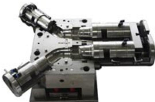
Extrusion-soufflage de conduits
